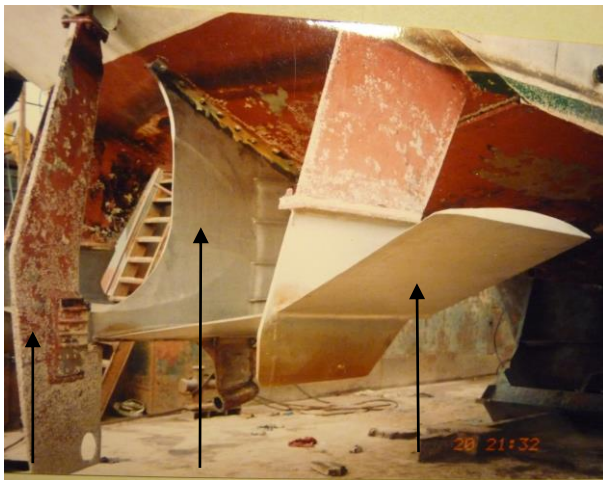
a. Cánh ngầm sau và bánh lái tàu (ảnh chụp khi tàu nằm trên ụ nổi, nhìn từ lái lên)
